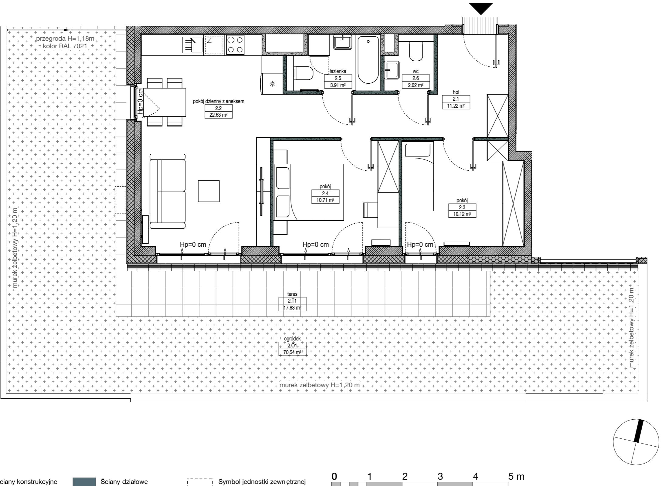
Ściany konstrukcyjne i kominy - elementy stałe      Ściany działowe nadające się do demontażu.      Symbol jednostki zewnętrznej klimatyzacji- po stronie kupującego
